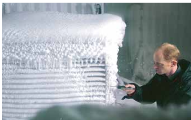
Klimaatkamers simuleren alle mogelijke bedrijfsomstandigheden
